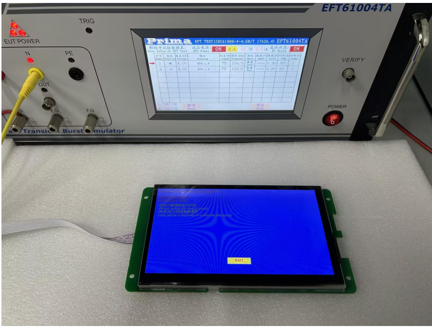
图 5-4 群脉冲测试图
